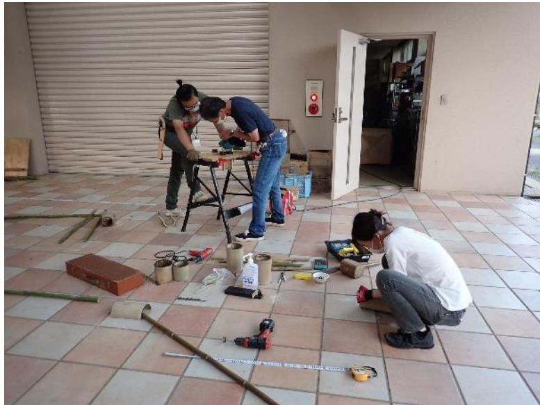
グラインダーで割り口を磨ききれいにする作業 とモウソウチクの穴あけ作業
