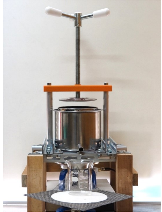
写真 10 加熱式に加工したハンドプレスジュースャー
