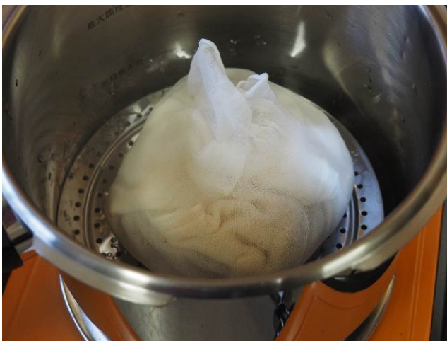
写真 8 蒸し皿とガーゼフィルターに入れた供試体
