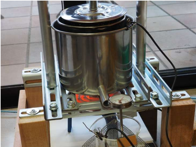
写真 11 架台下から電熱線で加熱
